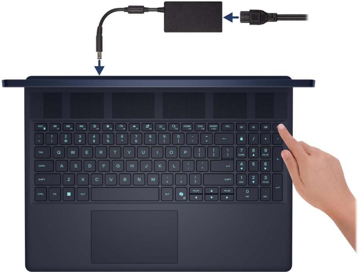
Rakam 8. Güç adaptörünü takıp güç düğmesine basın
