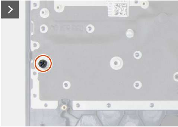
Rakam 99. SSD vida bağlantı parçalarını çıkarma
