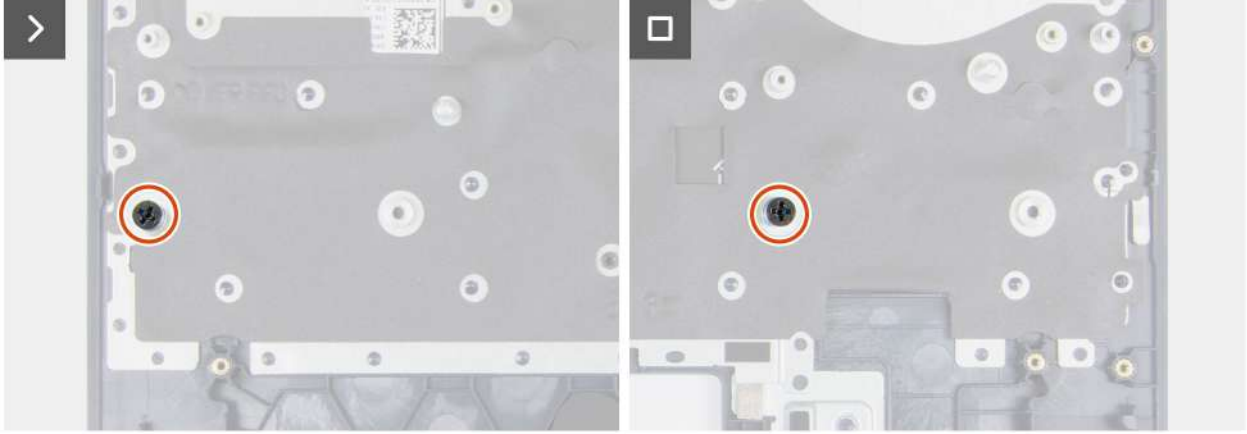
Rakam 100. SSD vida bağlantı parçalarını takma
